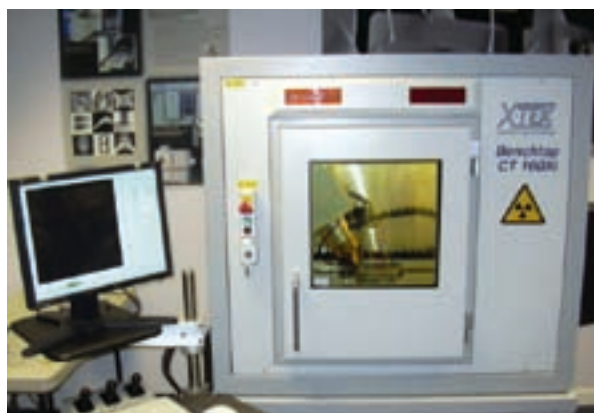
Рис. 1. Рентгеновский микротомограф Benchtop CT 160 Xi; а) фотография аппарата, б) внутренняя часть измерительной камеры устройства: 1 – рентгеновская пушка, 2 – манипулятор, 3 – детектор
