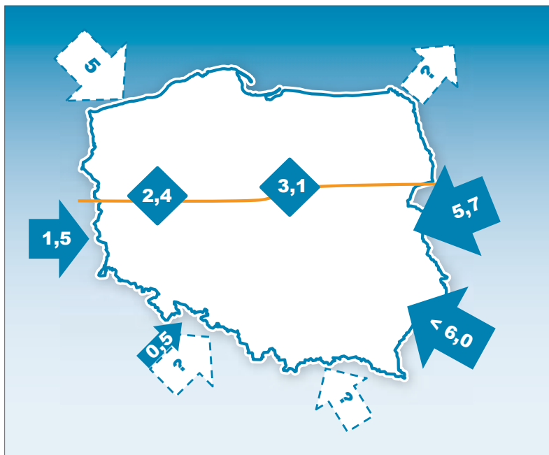
Rys. 1. Obecne i planowane zdolności importowe polskiej infrastruktury gazowej (w mld m 3 rocznie). Źródło: PwC
