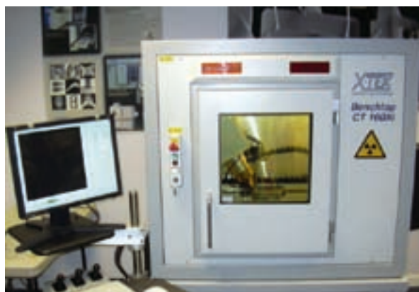
Rys. 1. Mikrotomograf rentgenowski Benchtop CT 160 Xi
