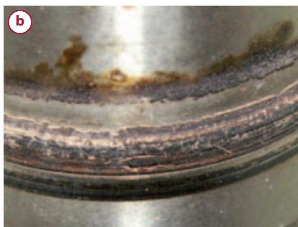
Rys. 2. Widok zanieczyszczonego osadami filtra paliwa; a) osady na powierzchni wkładu filtra w powiększeniu, b) widok ogólny filtra
