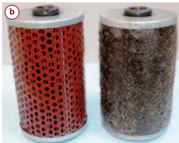
Rys. 2. Widok zanieczyszczonego osadami filtra paliwa; a) osady na powierzchni wkładu filtra w powiększeniu, b) widok ogólny filtra
