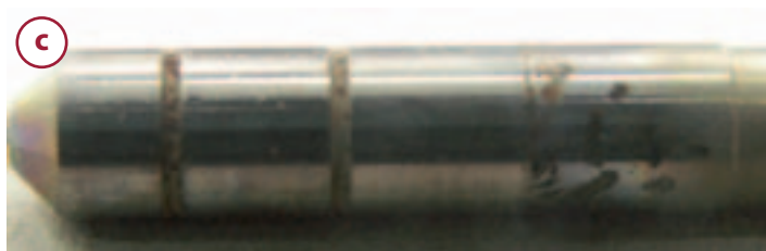
Rys. 3. Widok osadów wewnętrznych w połączeniu z korozją elementów wewnętrznych pompy wysokiego ciśnienia układu HPCR oraz wtryskiwacza paliwa; a, b) wałek napędowy pompy, c) tłoczek sterujący zaworu wtryskiwacza
